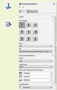
Klickt man auf eine Fläche, bevor der Bohrungsassistent gestartet wird, weiß SolidWorks, dass auf dieser Fläche die Bohrung platziert wird.
